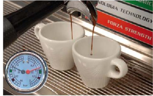
Manómetro doble, la aguja roja mide la presión interna de la caldera y la negra la presión a la que está pasando el agua por el café.
