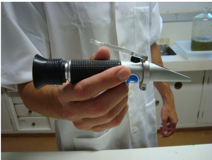
FIGURA 17 – Refratômetro utilizado para medição do °BRIX do mosto.
