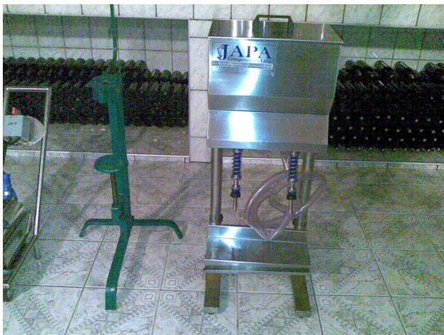
FIGURA 6 – Engarrafador e aparelho para colocação das rolhas.
