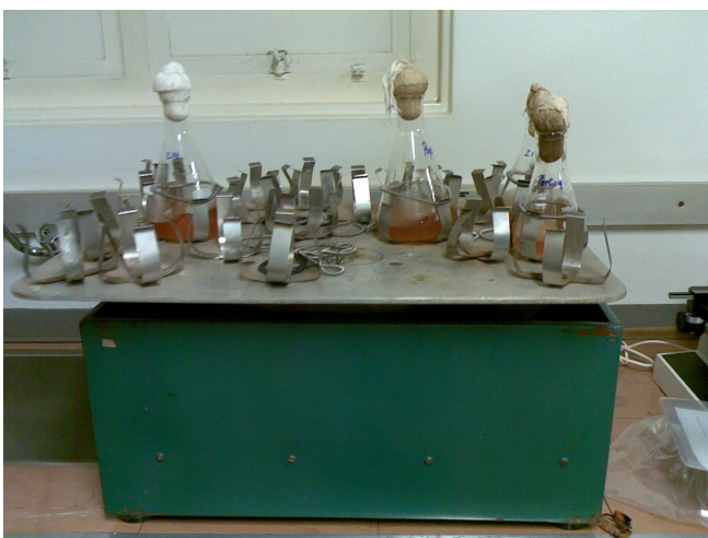
FIGURA 11 – Agitador de mesa utilizado para a multiplicação dos inóculos.
