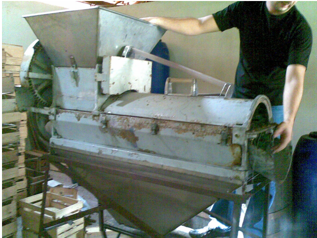
FIGURA 2 – Desengaçadeira e prensa utilizada na propriedade.
