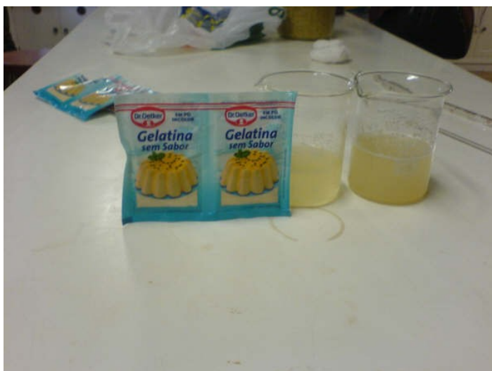
FIGURA 24 – Testes para a clarificação com gelatina
