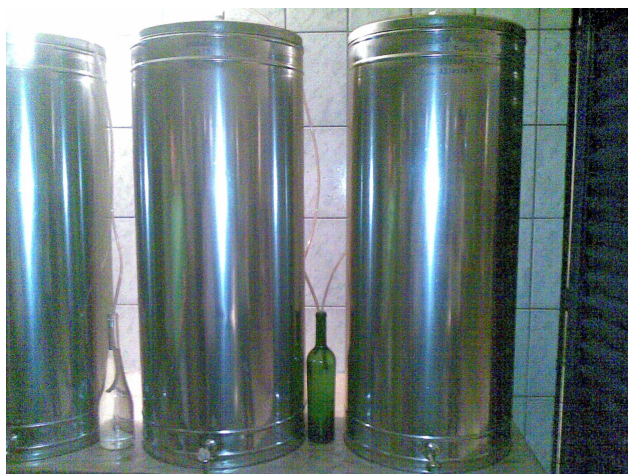
FIGURA 5 – Recipientes onde o vinho é colocado até o fim da fermentação lenta
