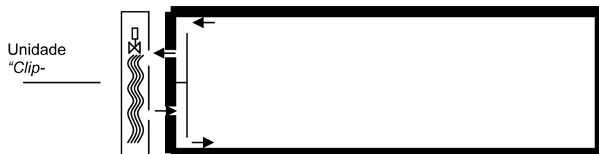
Figura 3.1 – Esquema de contentor “porthole” com unidade “clip-on”
