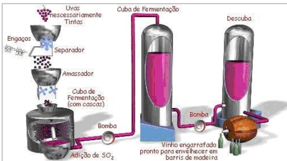
Figura 18 – Esquema de vinificação de vinhos tintos
