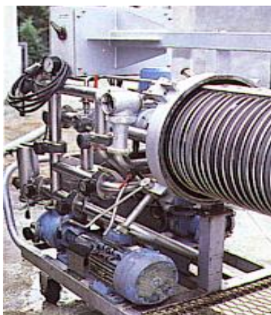
Equipamento de filtragem de diatomácea
