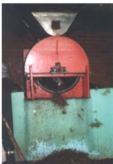
Máquina de desengaçamento em operação (esquerda) e o engajo recolhido ao final da operação
