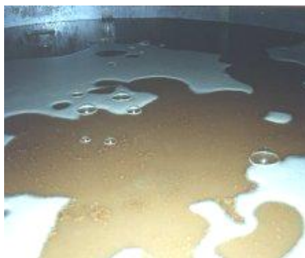
Vista interna do tanque de fermentação de vinho branco, notando-se o mosto amarelado e a espuma resultante da liberação de \text{CO}_2
