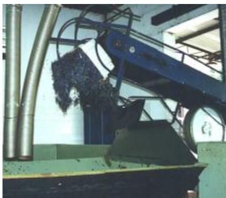
Lançamento das uvas no tanque de recepção
