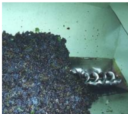
Eixo helicoidal que conduz as uvas para o desengaçador
